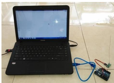
Gambar 7. Rangkaian Sistem Telemetri untuk receiver
