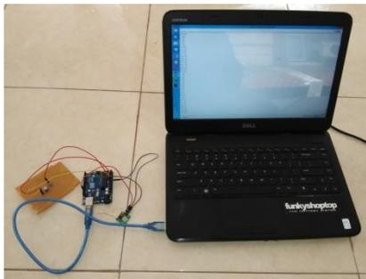
Gambar 6. Rangkaian Sistem Telemetri untuk transmitter
