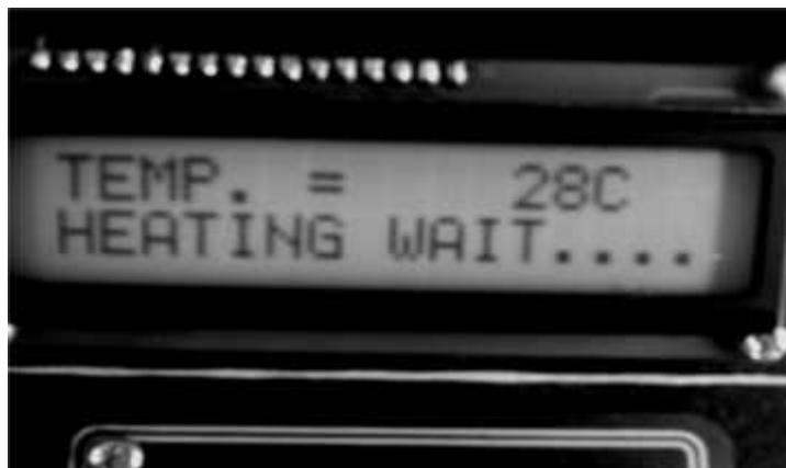
Gambar 15. Tampilan pada saat pemanasan.
