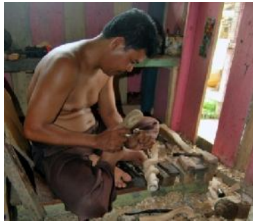
Gambar 7. Pemahatan kayu untuk tuas/ handle persneling mobil (Foto: Nofrial, 2013)
