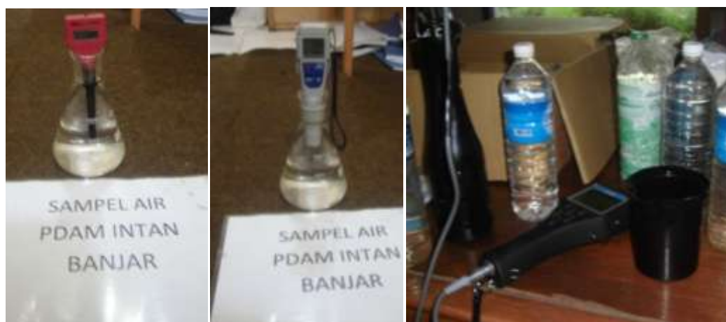
Gambar 2 Contoh uji kadar asam dan alkali menggunakan pH meter, uji kadar garam dengan EC meter, dan penggunaan Water Quality meter untuk mengetahui kualitas air.
