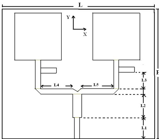
Gambar 4. Konfigurasi rancangan antenna susun dua *patch*.
