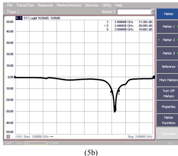
Gambar 5. (a) Grafik Frekuensi Vs *Return Loss* hasil simulasi. (b) Grafik Frekuensi Vs return loss hasil pengukuran
