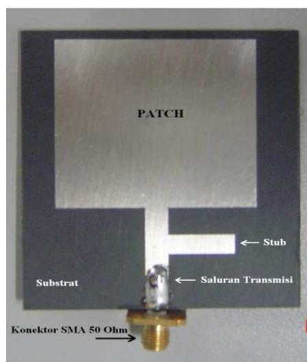
Gambar 2. Prototip antenna mikrostrip satu elemen patch[8].
