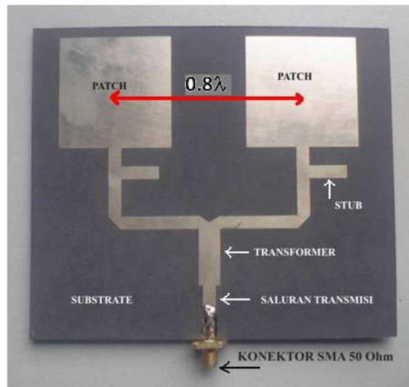
Gambar 10. Prototip antenna susun mikrostrip dua elemen patch.
