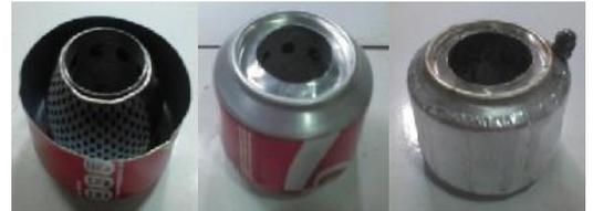
Tutup inner pipe dengan outer pipe
