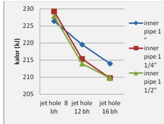
Gambar 4.3 grafik kalor yang diserap fungsi jumlah *jet hole* dan diameter *inner pipe*
