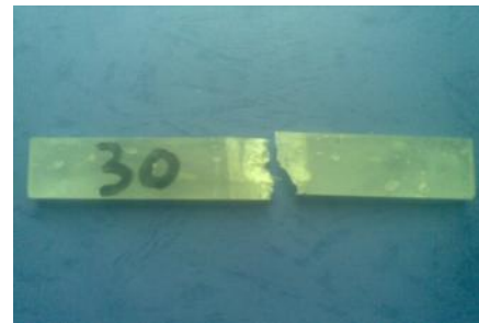
Gambar 4.21. Foto makro hasil uji bending dengan volume serat 30 %
