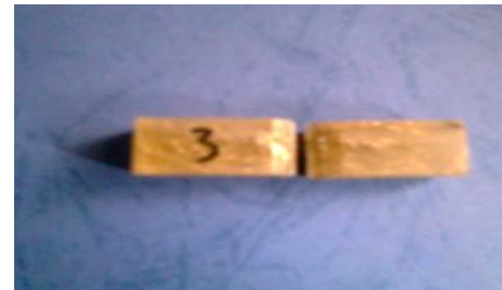
Gambar 4.9 Foto makro hasil uji impact dengan panjang seart 3 cm
