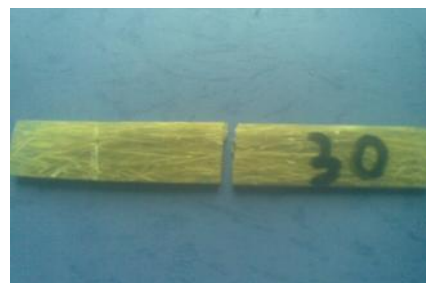
Gambar 4.18 Foto makro hasil uji bending dengan volume serat 30%
