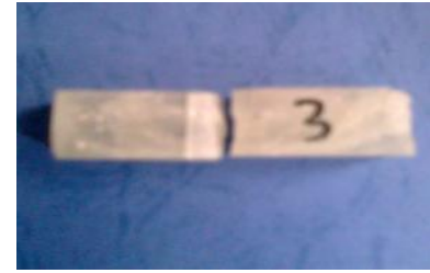
Gambar 4.12. Foto makro hasil uji impact dengan panjang serat 3 cm
