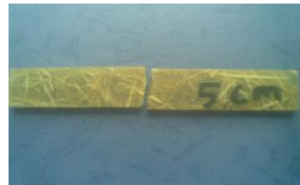
Gambar 4.26. Foto makro hasil uji bending dengan panjang serat 5 cm
