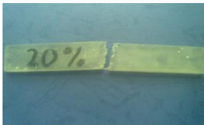
Gambar 4.20 Foto makro hasil uji bending dengan volume serat 20%
