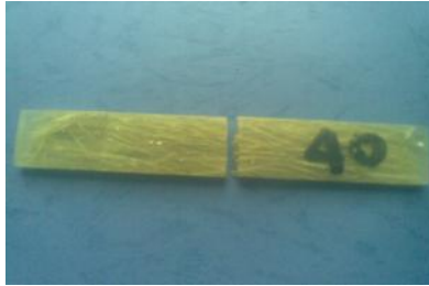
Gambar 4.19 Foto makro hasil uji bending dengan volume serat 40 %
