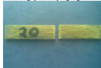
Gambar 4.17. Foto makro hasil uji bending dengan volume serat 20%
