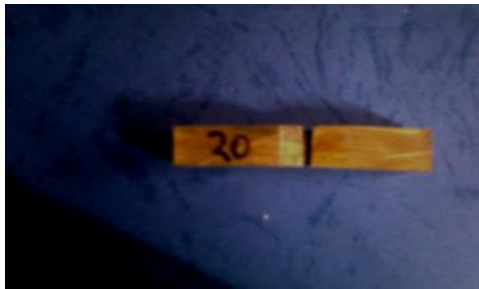
Gambar 4.2 Foto makro specimen uji impact dengan volume serat 20%
