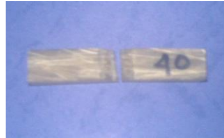
Gambar 4.6 Foto makro hasil uji impact dengan volume serat 40%
