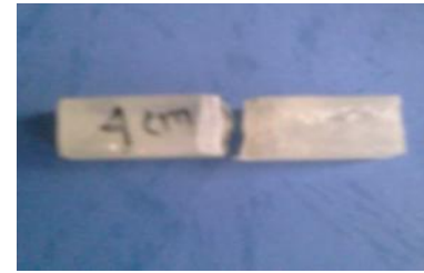
Gambar 4.13. Foto makro hasil uji impact dengan panjang serat 4 cm
