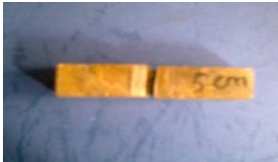
Gambar 4.11 Foto makro hasil uji impact dengan panjang serat 5 cm
