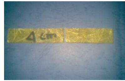
Gambar 4.25 Foto makro hasil uji bending dengan panjang serat 4 cm
