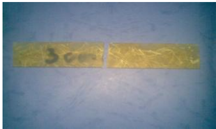
Gambar 4.24 Foto makro hasil uji bending dengan panjang serat 3 cm
