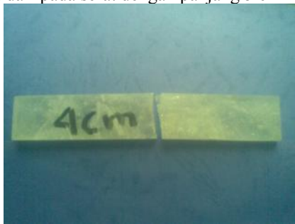
Gambar 4.28 Foto makro hasil uji bending dengan panjang serat 4 cm
