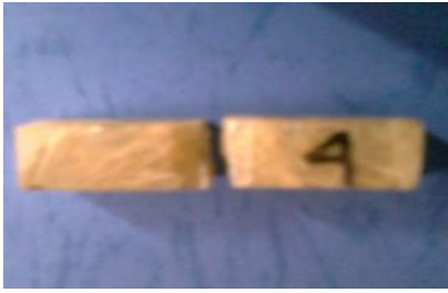
Gambar 4.10. Foto makro hasil uji impact dengan panjang serat 4 cm
