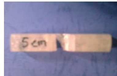
Gambar 4.14 Foto makro hasil uji impact dengan panjang serat 5 cm
