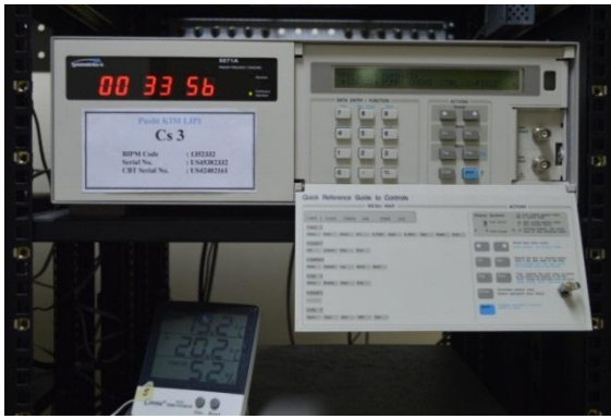
Gambar 4. Standar primer frekuensi HP-5071A di Puslit Metrologi LIPI
