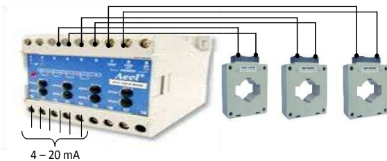
Gambar 7. Sensor dan Transduser untuk Arus Heater
