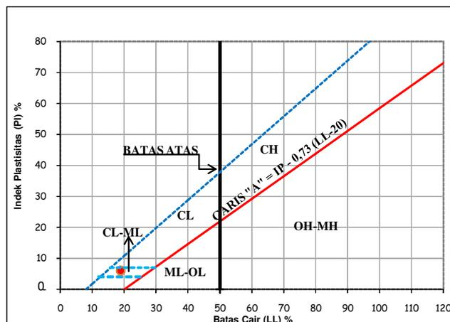
Gambar 4. Diagram Plastisitas Tanah Berbutir Halus Sistem *USCS*
