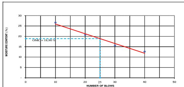
Gambar 3. Hasil Pengujian Batas Cair Material *CTRB*
