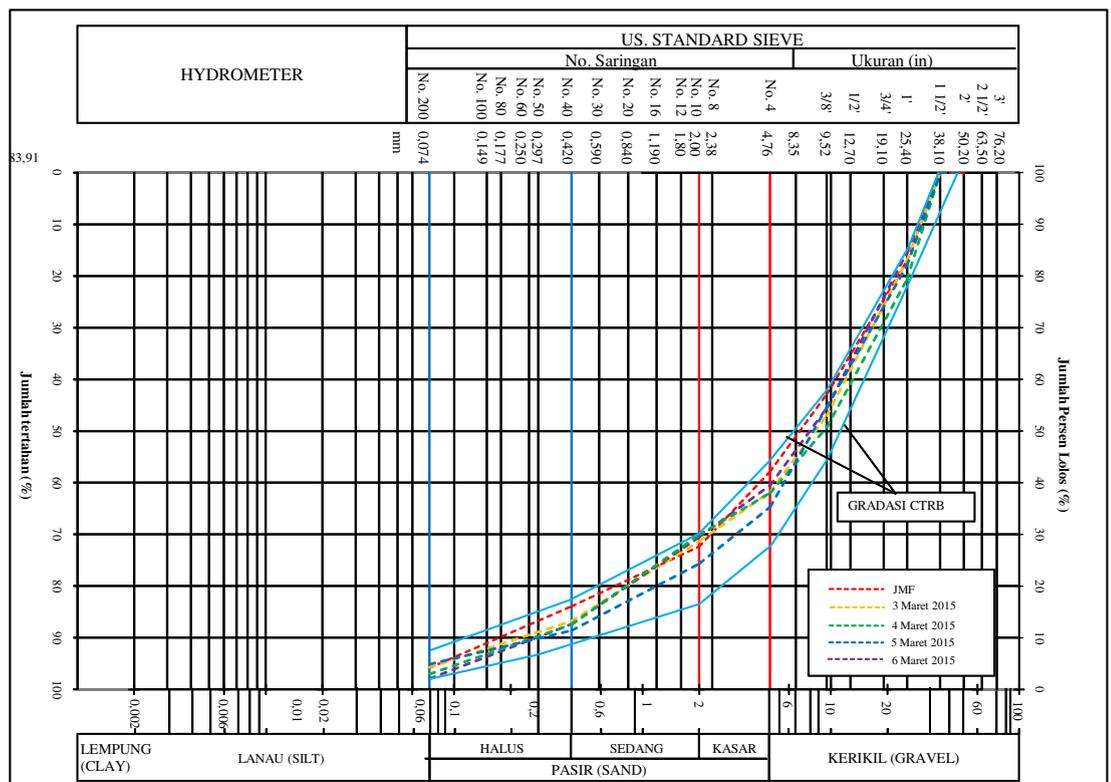
Gambar 8. Hasil Uji Distribusi Ukuran Butir Material CTRB
