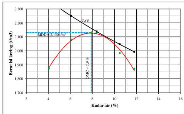
Gambar 10. Hubungan Kadar Air dengan Berat Isi Kering
