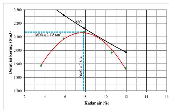
Gambar 6. Hubungan Kadar Air dengan Berat Isi Kering
