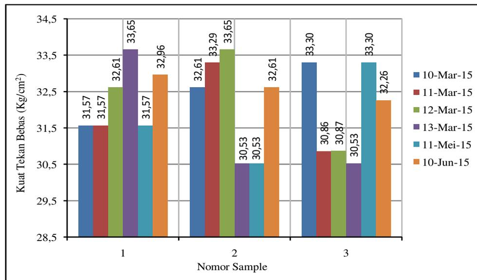
Gambar 11. Hasil Pengujian Kuat Tekan Bebas Campuran CTRB
