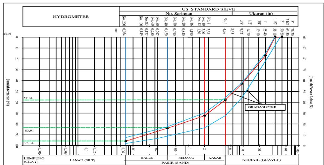
Gambar 2. Hasil Uji Distribusi Ukuran Butir Material *CTRB*
