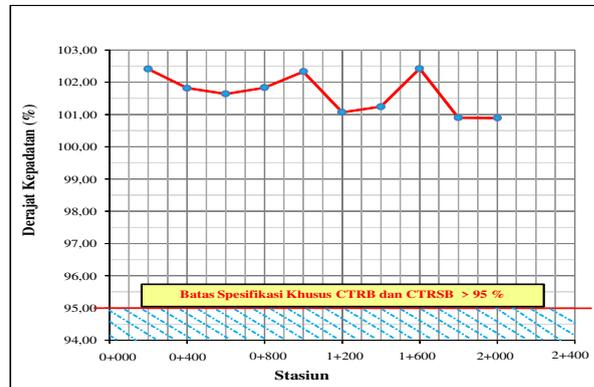
Gambar 12. Hubungan Stasiun titik Pengujian dengan Derajat Kepadatan *CTRB*
