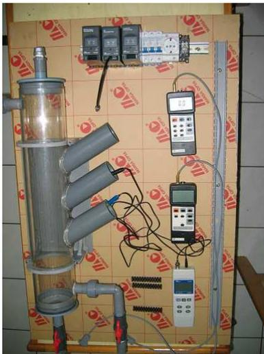
Gambar 8. Flow Cell yang dibuat pada kegiatan penelitian ini
