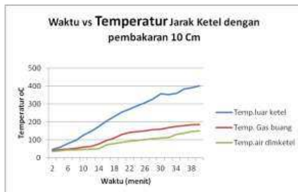
Gambar 3.2 Profil Temperatur pemanasan dengan jarak 10 Cm dari pembakaran
