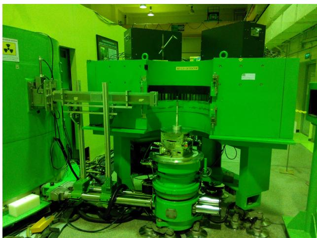
Gambar 1. Difraktometer Serbuk Resolusi Tinggi
