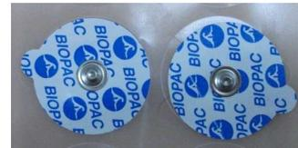
**Gambar 4.** Transduser Elektroda [2]
