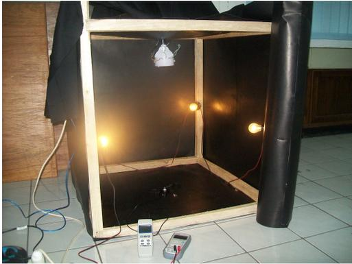
**Gambar 7.** Pengujian Intensitas dan Pengaturan Tingkat Pencahayaan
