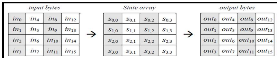
Gambar 1 Proses Input Bytes , State Array , dan Output Bytes Dikutip dari: Kriptografi, 2006, halaman 161
