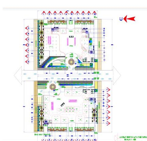
Untuk layout utilitas tapak memperlihatkan sistem utilitas yang berada diluar bangunan yaitu pada tapak. Untuk air hujan disalurkan dari talang ke riol kota. Untuk listrik pada lampu taman disalurkan dari panel distribusi jaringan listrik, dan untuk air bersih pada kolam yang ada pada tapak disalurkan dari PDAM.
