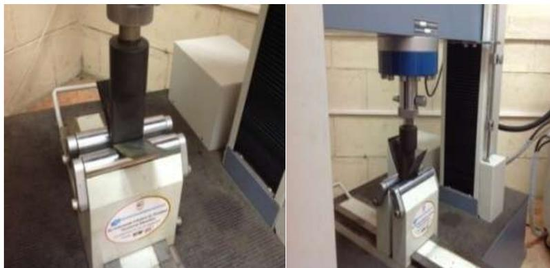
Gambar 3.4 Proses pengujian bending
