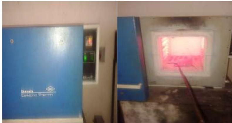
Gambar 3.2 Proses heat treatment pembentukan fasa ganda
