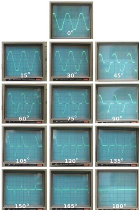
**Gambar 7 Perubahan bentuk gelombang sinusoidal terhadap penyalan sudut fasa.**
