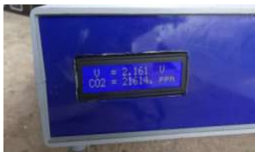
Gambar 13. Panel indikator CO 2 analyzer biogas tanpa pemurnian
