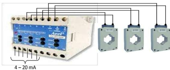
**Gambar 7.** Sensor dan Transduser untuk Arus Heater
