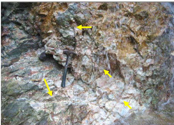
Gambar 3. Singkapan breksi andesitik terubah illitik ditembus urat-urat kuarsa tipis (tanda panah).
