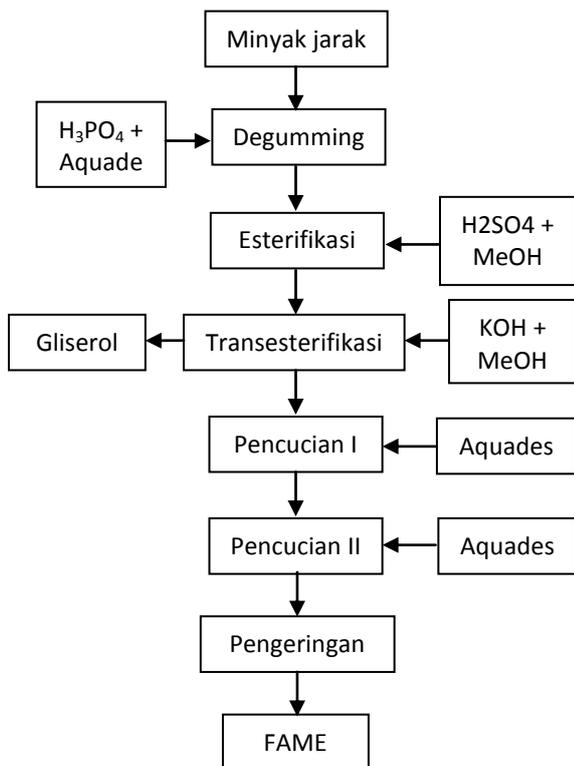
Gambar 1. Langkah-langkah pembuatan biodiesel minyak jarak pagar.
