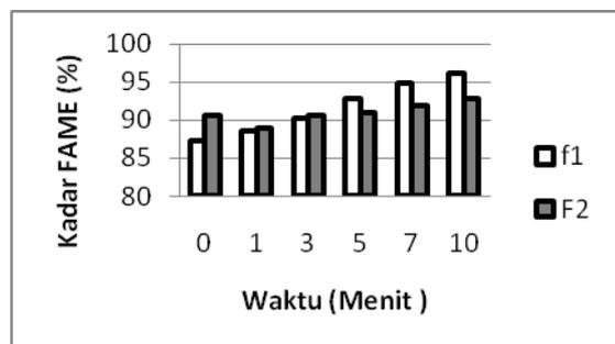
Gambar 2. Kandungan FAME biodiesel minyak jarak pagar pada berbagai perbandingan *co-solvent* dan lama pengambilan
