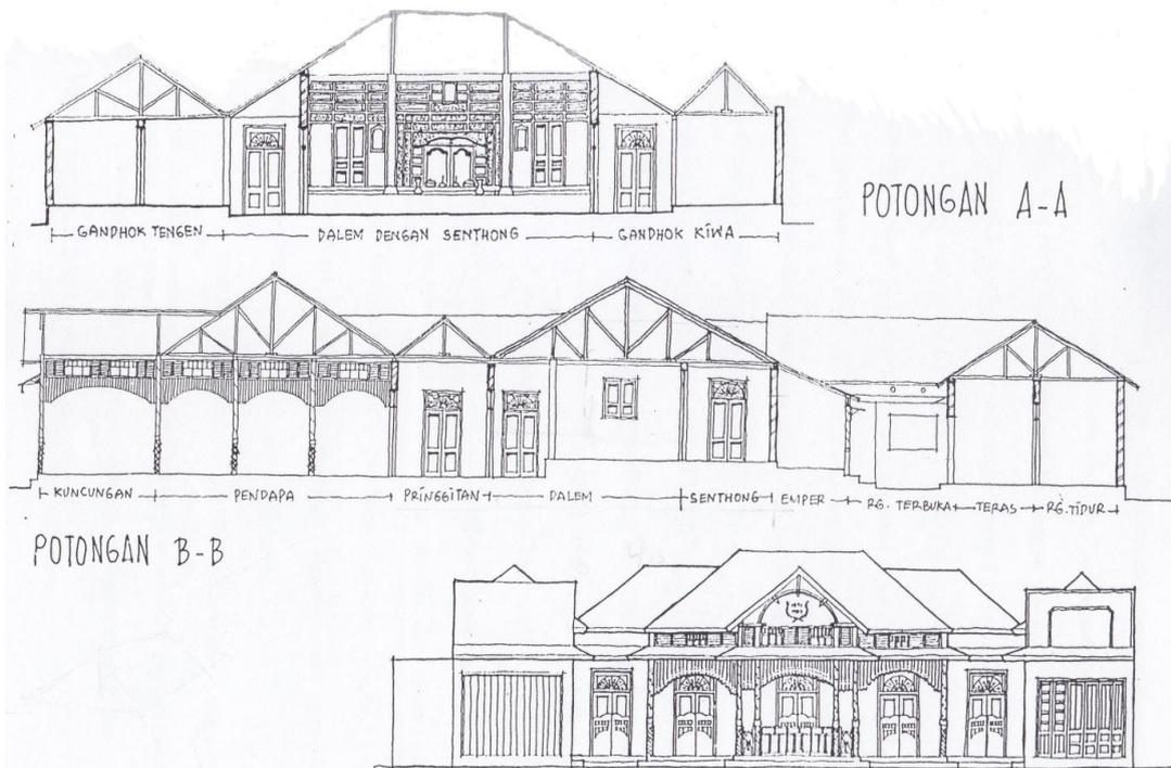
**Gambar 5.** Tampak dan potongan Rumah Kalang di Jl. Slamet Riyadi Surakarta (Hidayati, 2000). Pada gambar potongan terlihat adanya penggunaan konstruksi dinding 1 (satu) bata dengan atap pendopo berbentuk limasan dan komposisi fasad bangunan simetris
