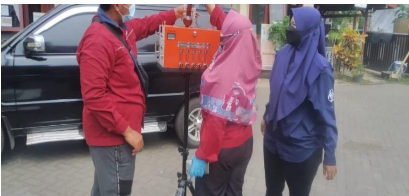
Gambar 2. Pemantauan Mutu Udara Ambien dengan Metode Grab Sampler
