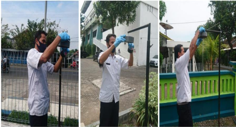
Gambar 3. Pemantauan Kualitas Udara Ambien dengan Passive Sampler
