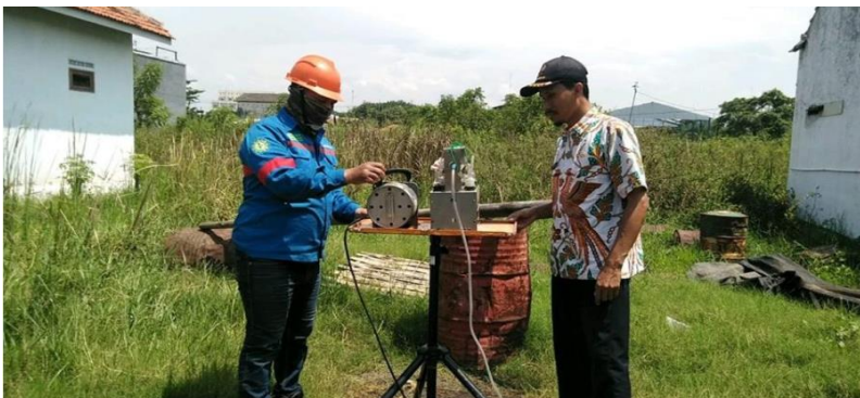
Gambar 1. Pemantauan Kualitas Udara Ambien dengan Metode Grab Sampler
