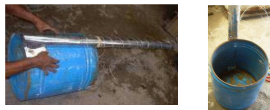
Gambar 5. Perakitan drum pengarangan dengan cerobong asap
