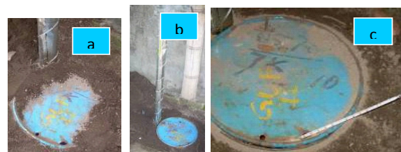
Gambar 13. Penutup tutup drum dengan tanah (a), proses pengarangan (b), dan pengukuran temperatur (c)
