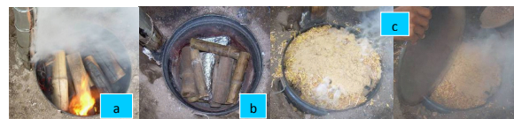
Gambar 12. Penyusunan bambu (a), pemberian bahan pematik (b), dan penutupan (c)
