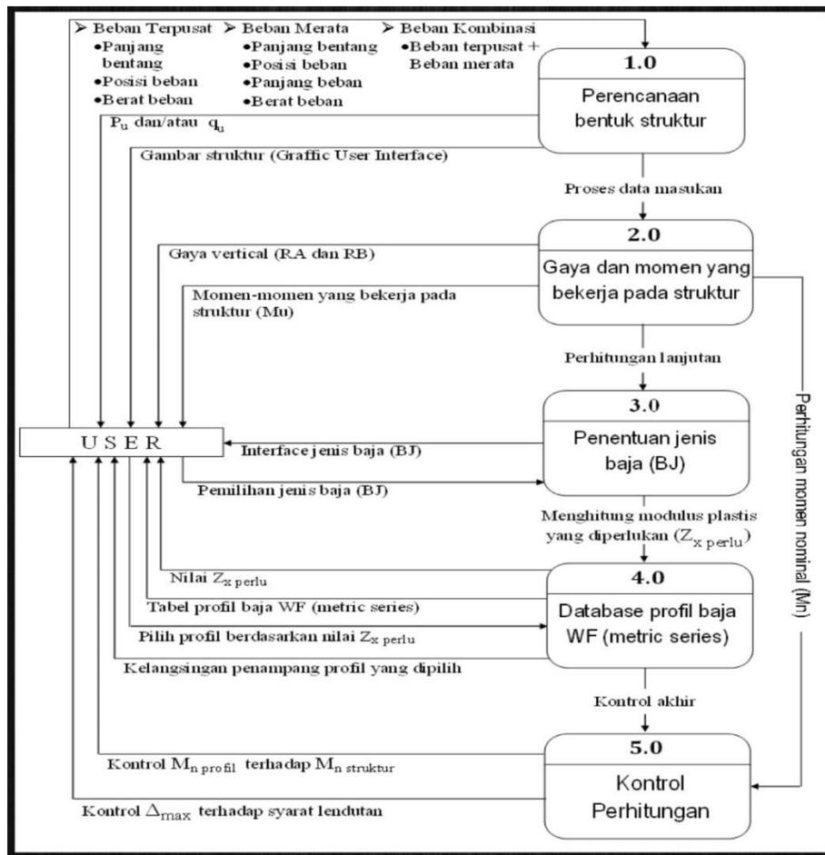
Gambar 5. Data Flow Diagram 0 sistem informasi desain balok terkekang lateral pada komponen struktur lentur
