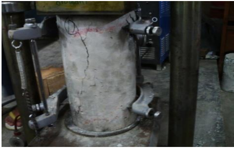
Gambar 7. Benda uji setelah pembakaran suhu 400°C.
