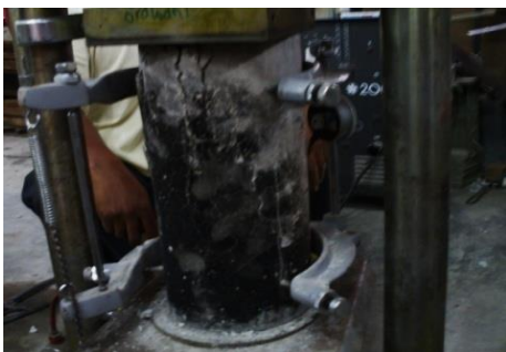
Gambar 8. Benda uji setelah pembakaran suhu 800°C.
