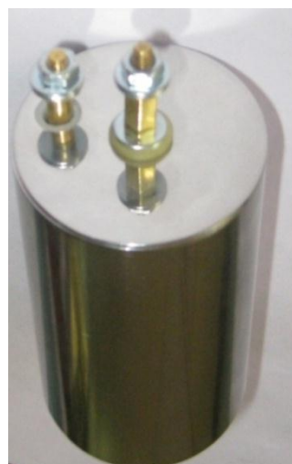
Gambar 5b. Konstruksi resistor shunt dalam kemasan
