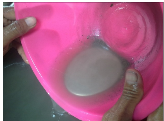
Gambar 7. Air raksa yang digunakan untuk mengikat butiran emas, sebagian akan tercampur dengan material lain
