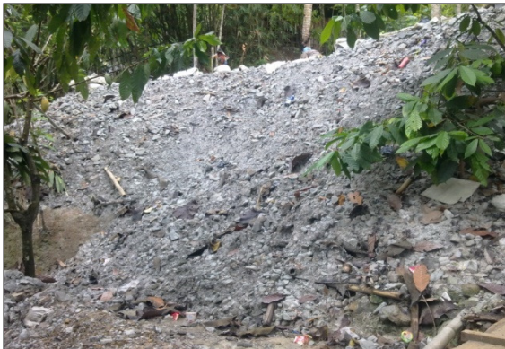
Gambar 2. Timbunan batuan samping ( disposal waste ) yang dianggap tidak mengandung bijih
