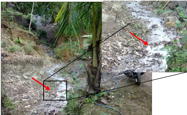
Gambar 5. Tailing yang dibuang langsung ke aliran sungai (tanda panah), bercampur dengan air dari pencucian batuan sampling
