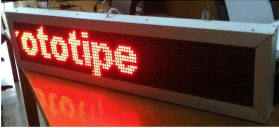
Gambar 10. Running Text Display menampilkan tulisan dari Android
