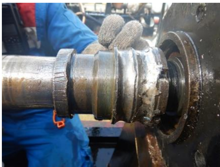
Gambar 6. Defect pada Outer dan Inner Bearing centrifugal feed pump
