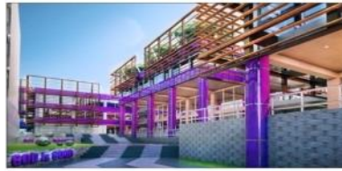
Tahap 3. Pada entrance diekspose kolom-kolom bulat selain berfungsi sebagai struktur berfungsi juga sebagai estetika.
