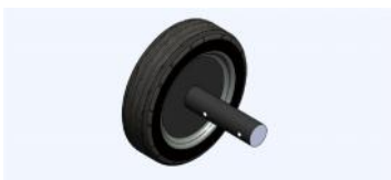
Gambar 10 Desain Batang poros pada roda
