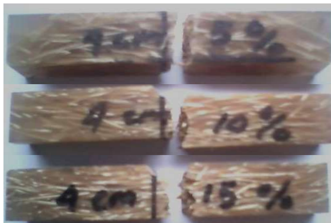
Gambar 6. Bentuk patahan spesimen uji impact menggunakan matrik polyester dengan panjang serat 4 cm
