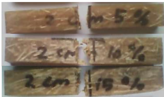
Gambar 5. Bentuk patahan spesimen uji impact menggunakan matrik polyester dengan panjang serat 2 cm
