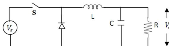
Fig. 1 Buck Converter
