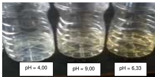
Gambar 4. Hasil uji kualitatif adsorpsi krom menggunakan arang aktif KOH 5% dengan waktu aktivasi 60 menit
