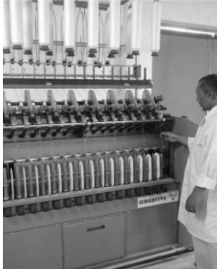
**Gambar 4.** Proses pembuatan benang *Slub*
