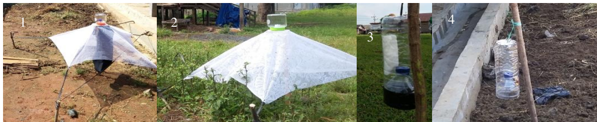
Gambar 2. Jenis perangkat, 1; Manitoba trap dengan kain hitam, 2: Manitoba trap tanpa kain, 3: Bottled trap dengan larutan gula dan cuka, 4: Bottled trap dengan sampah sisa makanan
