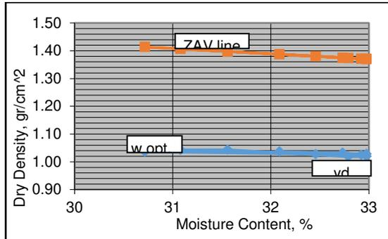
Gambar 1. Nilai kadar air optimum dan kepadatan kering pada pematatan
