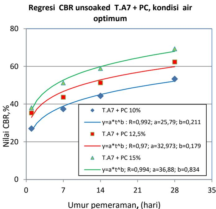
Gambar 2 Pengaruh Umur Pemeraman Terhadap Nilai CBR Tanah A7 + PC, Kondisi Air Optimum
