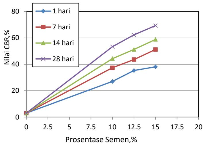
Gambar 3 Pengaruh Prosentase Semen Terhadap Nilai CBR Tanah A7+ PC, Kondisi Air Optimum
