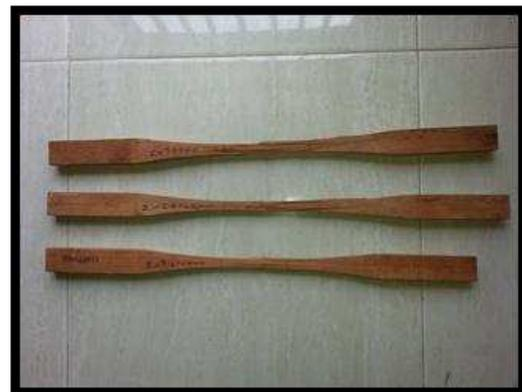
Gambar 7. Material Kayu Menggeris, setelah selesai pengujian
