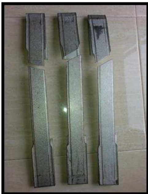
Gambar 2. Material baja ringan profil C 7,5/0,75 setelah selesai pengujian.
