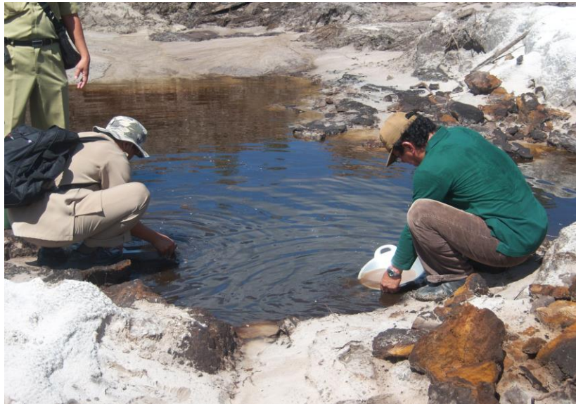
Gambar 8. Pengambilan mineral berat dengan metode dulang pada lokasi 2
