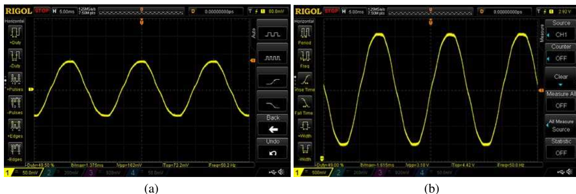
Gambar 6. Keluaran penguat sensor tegangan (a) sebelum dan (b) sesudah penguatan
