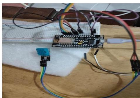
Gambar 6. Rangkaian DHT11
