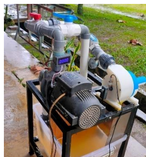
Gambar 5. Memasang turbin pada instalasi pengujian
