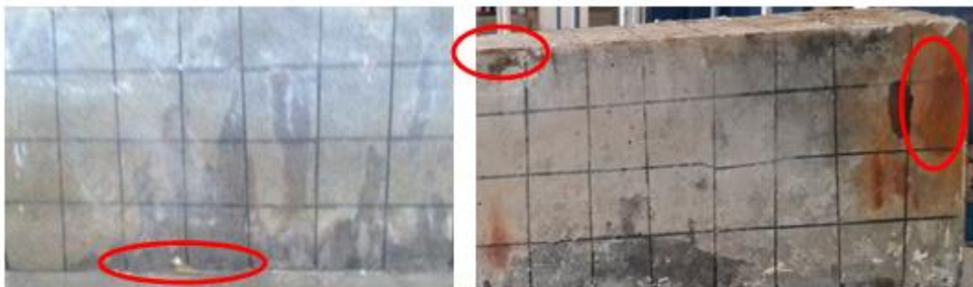
Gambar 8. Kondisi visual balok beton bertulang umur 2 tahun
