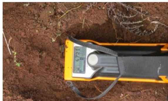
Gambar 10. Pembuatan tes pit soil sampai batuan dasar dan pengukuran radiometri tanah dengan ketebalan 75 cm di atas batuan dasar batugamping klastis.
