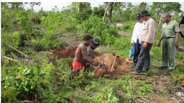
Gambar 10. Pembuatan tes pit soil sampai batuan dasar dan pengukuran radiometri tanah dengan ketebalan 75 cm di atas batuan dasar batugamping klastis.
