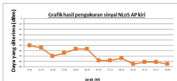
Gambar 3.3 Grafik Hasil Pengukuran Sinyal NLoS AP Kiri
