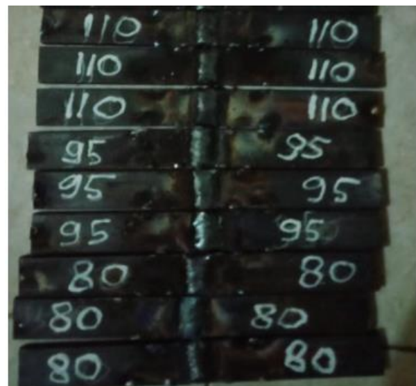
Gambar 2. Hasil pengelasan SMAW
