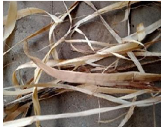
Gambar 6. Proses pembelahan pada serat kulit kayu waru
