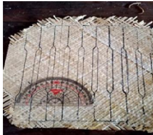
Gambar 9. Hasil pemotongan serat sesuai ukuran cetak spesimen uji
