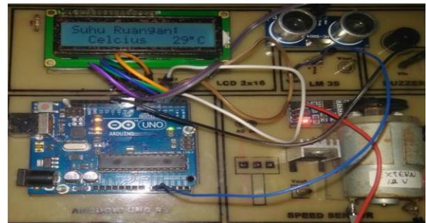
Gambar 6. Pengujian LM35 mengukur suhu ruang
